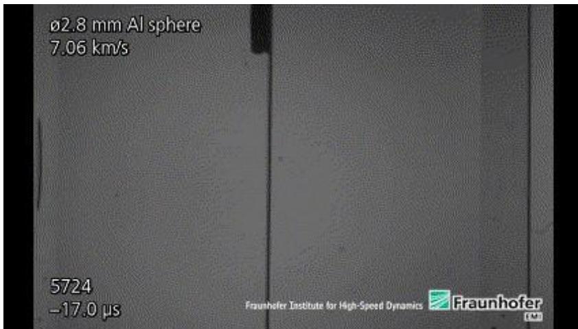
Figura 1: Colisión de una esfera de aluminio de 2,8 mm a hipervelocidad (Fuente: Fraunhofer Institute for High-Speed Dynamics)
